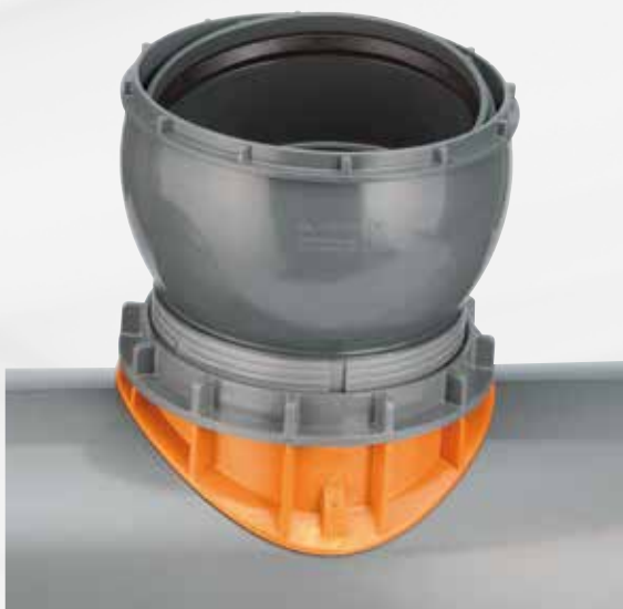
Navrtávací odbočky CONNEX DN/OD 160-200 s rozsahem 11°
