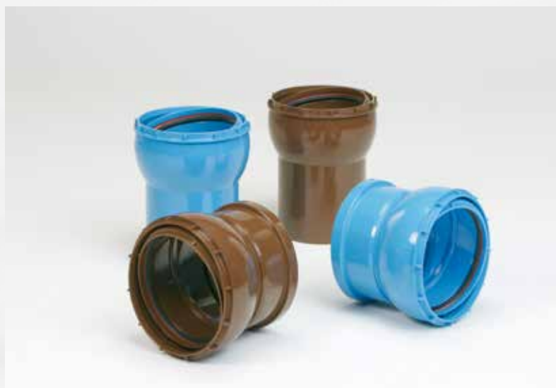
Výkyvná hrdla HS VARIO DN/OD 160-200 s rozsahem 11°
